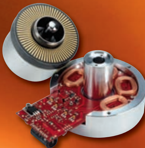
Direktantrieb mit Spulen und Antriebselektronik im Alu-Block, wartungsfreies Ölbad-Wälzlager, darüber der Ringmagnet mit Tachoscheibe
